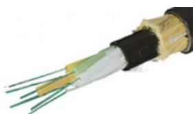
Figura 21 – Exemplo de cabo óptico com 12 fibras ópticas. [5]
